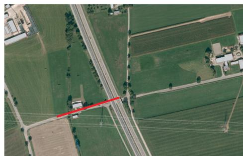
Zur Zeit wird eine neue Brücke am Kämmelweg über den Zeller Bach gebaut. Anschließend wird die Autobahnnunterführung etwas tiefer gelegt, damit in Zukunft auch höhere Fahrzeuge durchfahren können.
